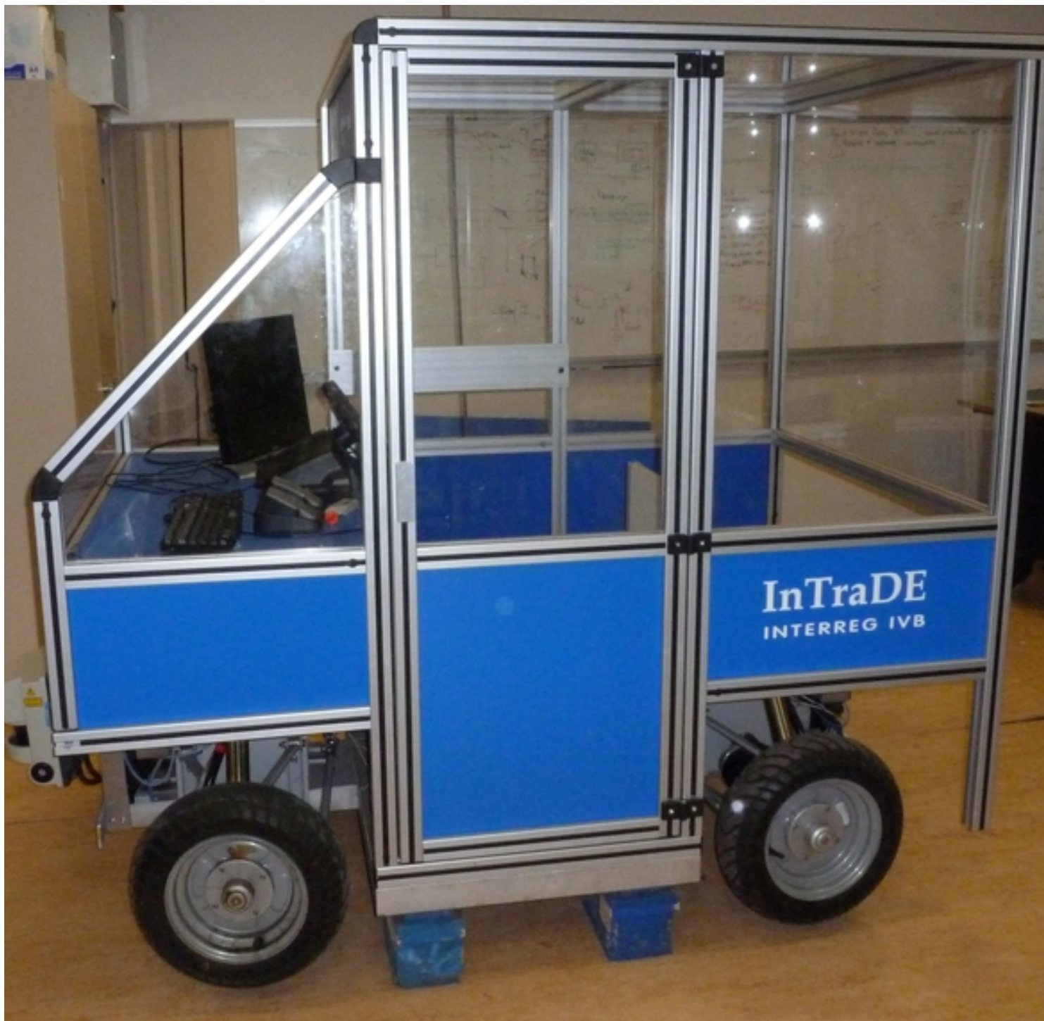
Photo du véhicule électrique autonome «Robucar» développé dans le cadre du projet européen InTraDE
